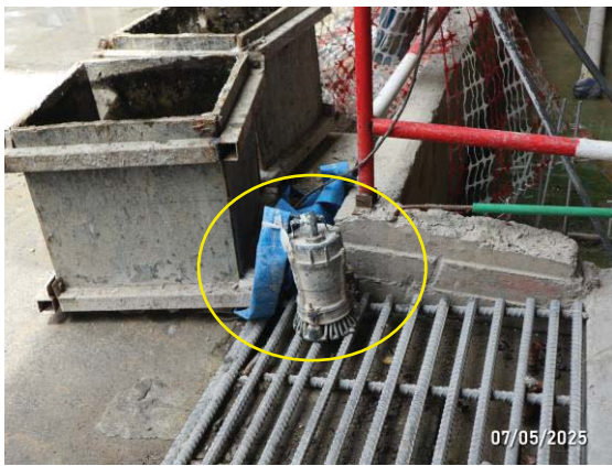
รูปที่ 3-44 เครื่องสูบน้ำประจำโครงการ
