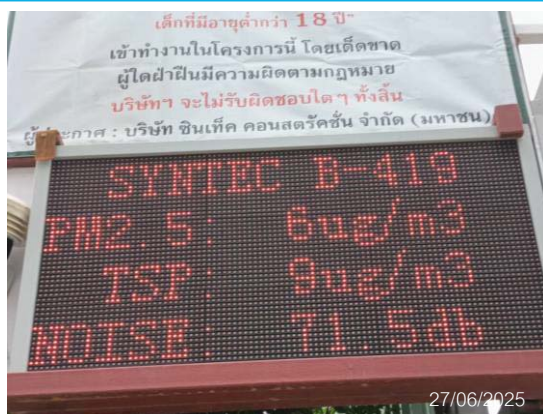
รูปที่ 3-25 เครื่องตรวจวัดคุณภาพอากาศและเสียง แบบ Real Time
