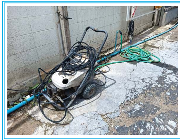
รูปที่ 3-32 เครื่อง Water Jet และพื้นที่สำหรับล้างล้อรถบรรทุกก่อนออกจากพื้นที่โครงการ
